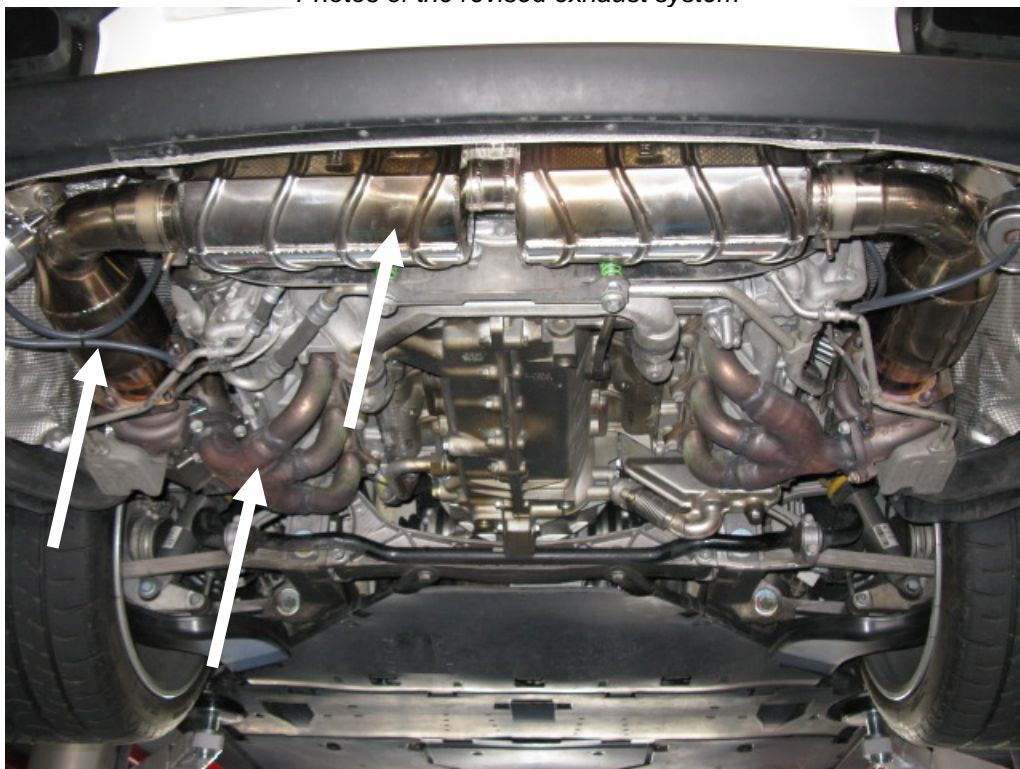
Pfeile von links nach rechts:Katalysator, Serienkrümmer, Endschalldämpfer Arrows from the left to the right: catalyst, series exhaust manifold, changed rear silencers
